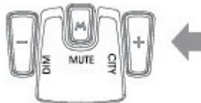
В современных городах, и в промышленных зонах ваш детектор может столкнуться с множеством слабых радиосигналов, не относящихся к сильным сигналам полицейского радара (сигналы микроволновых антенных мачт, устройств автоматического открывания дверей и т.п.). Чтобы детектор не реагировал на ненужные сигналы, в нем предусмотрен режим **City (Город)**, который значительно сокращает количество ложных срабатываний.
