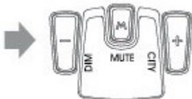
Последовательно нажимайте кнопку **DIM (-)**, чтобы установить нужную яркость подсветки дисплея в зависимости от условий освещения. Вы можете выбрать следующие режимы яркости подсветки: слабая, темная или яркая.
