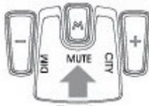
Нажмите кнопку **MUTE (M)**, чтобы отключить звуковой сигнал об обнаружении сигнала радара. Еще раз нажмите кнопку **MUTE (M)**, чтобы включить звук снова.
