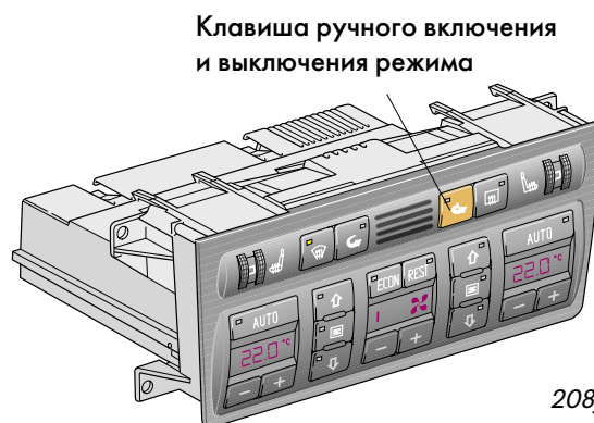
Панель управления установки с автоматическим управлением режимом рециркуляции
